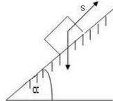
22. Тело весом  $G = 20$  н удерживается в равновесии на шероховатой поверхности. Угол наклона плоскости  $\alpha = 60^\circ$ , коэффициент трения  $f = 0.3$ . Определить минимальное значение силы  $S$  для удержания тела от скатывания вниз.
