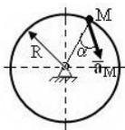
20. Ускорение точки **M** диска, вращающегося вокруг неподвижной оси  $a_M = 4 \text{ м/с}^2$ . Определить угловую скорость  $\omega$  этого диска, если  $R = 0.25$  м и угол  $\alpha = 60^\circ$ .
