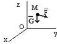
2. На материальную точку  $M$  массы  $m = 1\text{ кг}$ , кроме силы тяжести  $G$ , действует сила  $F = 9,8\text{ кН}$ . Ускорение свободного падения принять  $g = 9,8\text{ м/с}^2$ . В начальный момент точка двигалась вниз. Смотри рис. задания 1
