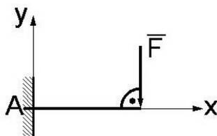
16. . Указать все ненулевые реакции невесомой консольной балки, на которую действует сила  $F$  ( $X, Y$  - реакции вдоль осей  $x, y$  соответственно,  $M$  - момент заделки).
