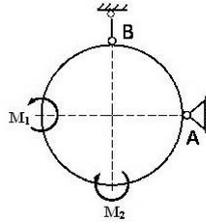
19. Невесомая изогнутая балка АСВ находится под действием двух пар сил, моменты которых соответственно равны  $M_1 = 3$  нм,  $M_2 = 12$  нм.  $AC = 3$  м,  $BC = 4$  м. Указать модуль реакции опоры В.
