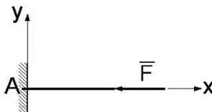
17. . Указать все ненулевые реакции невесомой консольной балки, на которую действует сила  $F$  ( $X, Y$  - реакции вдоль осей  $x, y$  соответственно,  $M$  - момент заделки).
