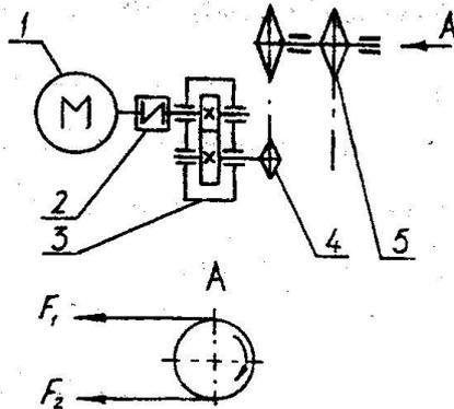
Кинематическая схема привода:
