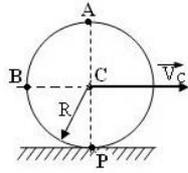
17. Диск радиуса  $R=10$  см вращается вокруг оси  $Ox$  по закону  $\varphi = 4+5t$  с<sup>-1</sup>. Найти ускорение точки **A** (м/с<sup>2</sup>).
