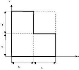
28. Определить вертикальную координату центра тяжести  $y_c$  однородной пластины. Смотририс. задания 27
