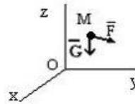
2. На материальную точку **M** массы  $m = 1$  кг, кроме силы тяжести  $G$ , действует сила  $F = 9,8k$ (Н). Ускорение свободного падения принять  $g = 9,8$  м/с<sup>2</sup>. В начальный момент точка двигалась вниз. Смотри рис. задания 1
