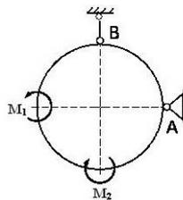
19. Невесомая изогнутая балка ACB находится под действием двух пар сил, моменты которых соответственно равны  $M_1 = 3$  нм,  $M_2 = 12$  нм.  $AC = 3$  м,  $BC = 4$  м. Указать модуль реакции опоры B.
