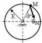
20. Ускорение точки **M** диска, вращающегося вокруг неподвижной оси  $a_M = 4$  м/с<sup>2</sup>. Определить угловую скорость  $\omega$  этого диска, если  $R = 0.25$  м и угол  $\alpha = 60^\circ$ .
