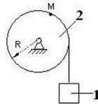
13. Скорость груза 1  $V_1 = 0.6 \text{ м/с}$ ; радиусы блоков соответственно равны 0.15 м и 0.2 м. Определить скорость груза 2.
