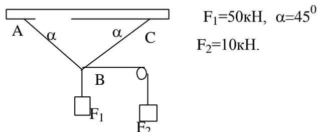
5. Проверить прочность и жесткость стального бруса, построить эпюры
