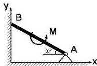
12. Невесомая балка  $AB$  длины 6 м опирается в точке  $B$  на гладкую вертикальную стену,  $M=12$  нм. Определить величину вертикальной реакции опоры  $A$  и силу давления балки на стену.
