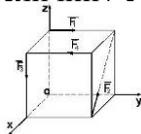
26. Силы  $F_1$  и  $F_2$ , пересекающие ось  $Z$ , параллельны соответственно осям  $OY$  и  $OX$ . Сила  $F_3$  лежит в плоскости  $XOY$  и составляет угол  $\alpha$  с осью  $OY$ . Расстояния  $a$ ,  $b$ ,  $c$ ,  $e$  показаны на рисунке. Определить проекцию на ось  $X$  главного момента сил.
