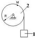
13. Скорость груза 1  $V_1 = 0.6$  м/с; радиусы блоков соответственно равны 0.15 м и 0.2 м. Определить скорость груза 2.
