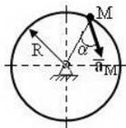
20. Ускорение точки  $M$  диска, вращающегося вокруг неподвижной оси  $a_M = 4 \text{ м/с}^2$ . Определить угловую скорость  $\omega$  этого диска, если  $R = 0.25 \text{ м}$  и угол  $\alpha = 60^\circ$ .
