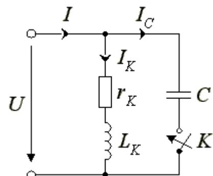
Определить показания ваттметра, если  $U = 200 \text{ В}$ ,  $R = X_L = X_C = 5 \text{ Ом}$ .
