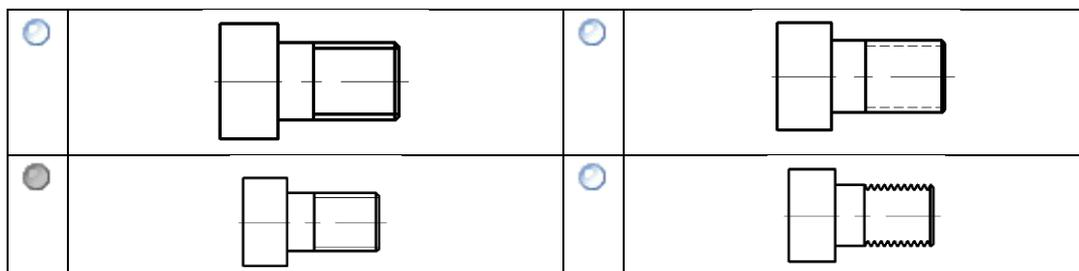
Правильное обозначение болта исполнения 2 с наружным диаметром резьбы 16 мм, мелким шагом 1,5 мм, длиной 50 мм по ГОСТ 7798-70...
