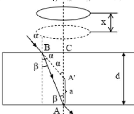
Существует связь между толщиной исследуемой стеклянной пластинки, высотой кажущегося подъема предмета (подъема тубуса микроскопа) и показателем преломления стекла. Для установления этой связи рассмотрим ход лучей от точки А (см. рисунок) через стеклянную пластинку. При этом будем предполагать, что глаз находится на той нормали к плоскостям пластинки, которая проходит через точку А, и луч АВ составляет с нормалью малый угол  $\beta$ .
