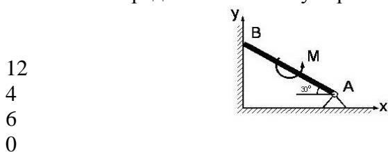
**12.** Невесомая балка **AB** длины 6 м опирается в точке **B** на гладкую вертикальную стену,  $M=12$  нм. Определить величину вертикальной реакции опоры **A** и силу давления балки на стену.
