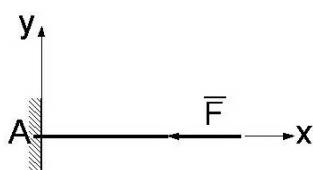
**17.** Указать все ненулевые реакции невесомой консольной балки, на которую действует сила **F** (**X**, **Y** - реакции вдоль осей **x**, **y** соответственно, **M** - момент заделки).
