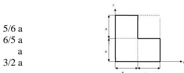
**28.** Определить вертикальную координату центра тяжести  $y_c$  однородной пластины. Смотри рис. задания 27
