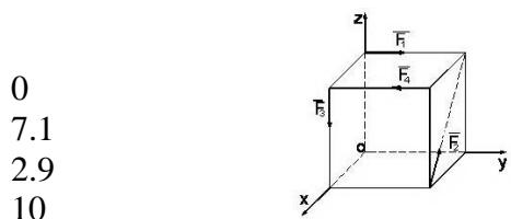
**26.** Силы  $\bar{F}_1$  и  $\bar{F}_2$ , пересекающие ось Z, параллельны соответственно осям 0Y и 0X. Сила  $\bar{F}_3$  лежит в плоскости X0Y и составляет угол  $\alpha$  с осью 0Y. Расстояния a, b, c, e показаны на рисунке. Определить проекцию на ось X главного момента сил.
