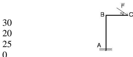
10. На Г-образную раму АВС с жёсткой заделкой в точке А действует в плоскости рамы сила  $\bar{F} = 10$  н,  $AB = 3$  м,  $BC = 2$  м. Определить величину вертикальной силы реакции заделки.
