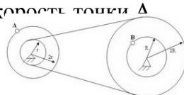
6. Два шкива (см. рис. задачи 5) соединены ремённой передачей. Скорость точки A одного из шкивов  $V_B=48 \text{ см/с}$ . Найти угловую скорость шкива с точкой B, если  $R=12 \text{ см}$ .
