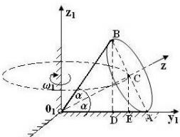
угловую скорость  $\omega_1 = 2 \text{ с}^{-1}$ ;  $\alpha = 30^\circ$ ,  $O_1C = 20 \text{ см}$ . Для заданного положения конуса определить его угловую скорость, а также линейные скорости точек **A, B, D, E**.
